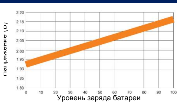
Зависимость напряжения от уровня заряда (20°C)
